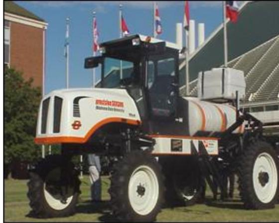
Figura 5. El aplicador Cherokee, este aspersor cubre 18 m en un pase y cuenta con sensores montados cada 0.6 m.
